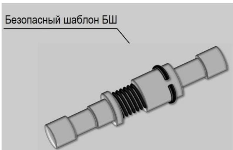
Устройство спускается в скважину на технологических трубах НКТ. Если в процессе спуска в скважине обнаруживается сужение э/колонны диаметром меньше выдвижных пластин безопасного шаблона, то происходит прихват подвижных пластин в месте препятствия.
